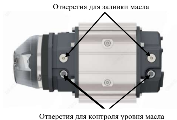
Рисунок 14. Заливка и контроль уровня масла при установке счетчика G16-G400 на вертикальном участке трубопровода
